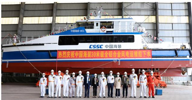
随着海上装机容量的不断增加，一排排整齐的风机屹立于海面之上，使得海上风电运维市场的潜力逐渐显现，这也不断推动了海上运维的高要求、专业化。针对市场变化和客户需求，中国海装高度重视海上风电场运维能力的建设，“中国海装001”具有优良的安全性、快速性、防腐性、耐波性、舒适性和可达性，可实现山东、江苏、浙江、福建等不同海域的高效运维，船身采用全铝合金结构，总长30.05米、总宽9.9米、型深3.2米、吃水1.7米，设计航速25节，最大装载38吨，可抗浪高4米，可搭乘12名运维人员和6名船员。将为海上风电运维提供专业化的保障服务，为海上风电运维人员提供安全的、舒适的工作环境。
