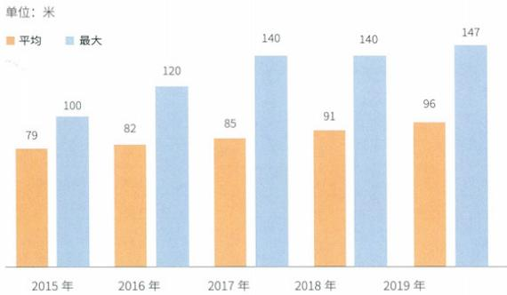
中东部低风速区域风资源具有高风切变的特点，按照0.3的风切变计算，高度从100m增加到140m，年平均风速将从5.0m/s增加到5.53m/s。因此，提高轮毂高度能使机组获取更好的捕风效益，大幅提高发电量，创造更多绿色能源。
