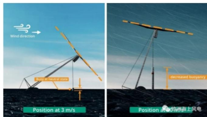
TouchWind认为，单叶片风机在浮式风电领域将有很强的竞争力。TouchWind表示，他们的设计可在最高70米/秒的风速下运行，因此适用范围很广；最大的优势则是单叶片和无塔筒带来的低成本。
